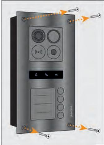
Entfernen Sie alle Befestigungsschrauben.
