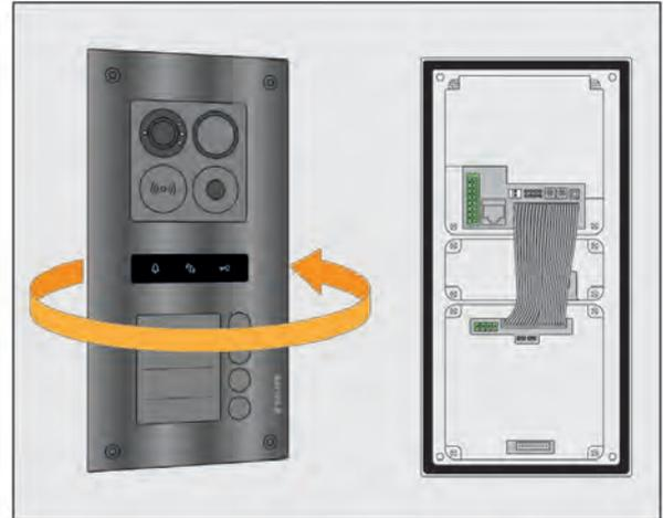
Drehen Sie die Türstation. Die Anschlusspanele befinden sich auf der Rückseite.
