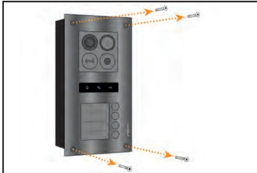
Entfernen Sie vorsichtig die Befestigungsschrauben mit einem Schraubendreher.
